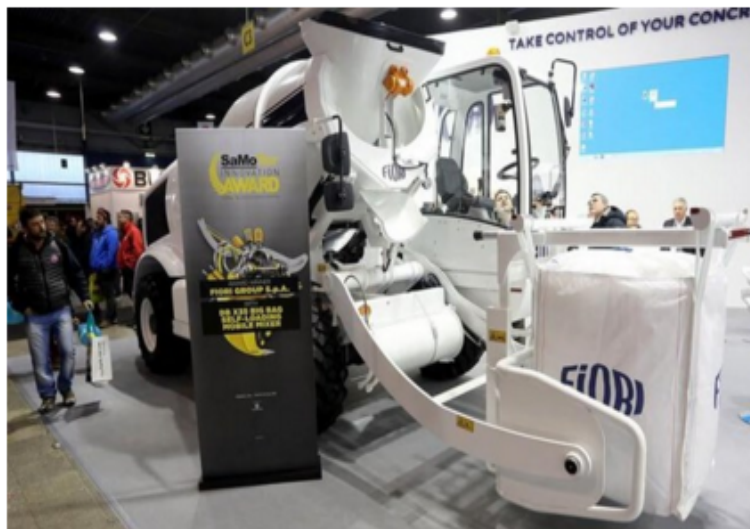
Der selbstbefüllende Fahrmischer „DB X35 Big Bag“ der Fiori Group wurde 2017 ausgezeichnet. | Foto: Foto Veronafiore-ENNEVI
