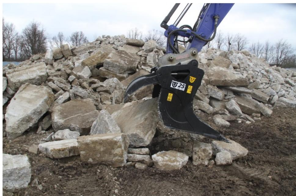
La benna consente il carico e lo scarico sia nel verso frontale che posteriore di inerti di varia natura e offre una movimentazione mirata di materiali di notevoli dimensioni. E' indicata per le imprese edili e stradali e le imprese di demolizione vista la sua duttilità e la possibilità di scavare e movimentare materiale con un'unica attrezzatura. Evidenti i vantaggi che offre la possibilità di caricare e movimentare materiali di grosse dimensioni con un'unica attrezzatura:
