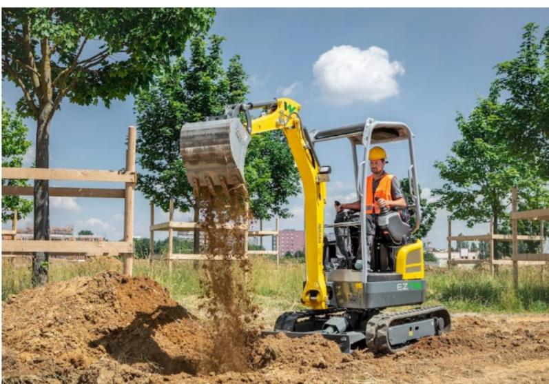
Il primo mini escavatore completamente elettrico a batteria di **Wacker Neuson EZ17e** lavora e si usa proprio come un modello diesel. Per questo sviluppo tecnico, la giuria del "Samoter Innovation Award 2020" gli ha assegnato il premio per l'innovazione nella categoria miniescavatori idraulici.
